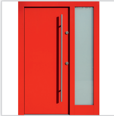
Drzwi wejściowe zewnętrzne model 500C z opcjonalnymi dostawkami bocznymi we wspólnej ramie. Grubość [mm]: 72, 82 i 102. Wysokość ościeżnicy [mm]: 209. Szerokość całej zabudowy od 140 do 255 cm. Wyposażenie: zamek listwowy klasy „C” na dwie wkładki, 4 blokady antywłamaniowe. Szklenie: pakiet 3 lub 4 szybowy z szybą niskoemisyjną P1. Materiał: klejone warstwowo drewno mahoń-meranti. Ocieplenie [mm]: 58-84. Współczynnik przenikania ciepła U_g [W/(m 2 K)]: od 0,55. Gwarancja: do 4 lat.
