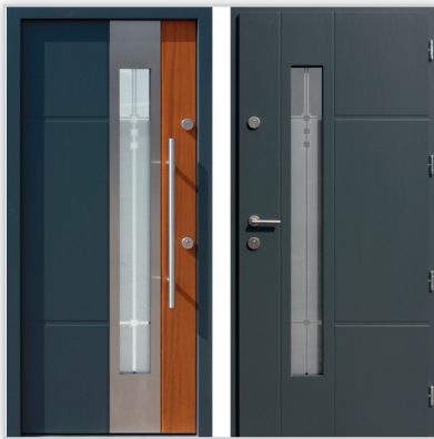
Drzwi wejściowe zewnętrzne model 449,1 systemu E-82. Wymiary zewnętrzne ościeżnicy [cm]: 98/209. Grubość [mm]: 72, 82 i 102. Wyposażenie: zamek listwowy klasy „C” na dwie wkładki, 4 kołki antywłamaniowe. Szklenie: pakiet 3 lub 4 szybowy z szybą niskoemisyjną P1. Materiał: klejone warstwowo drewno mahoń-meranti. Ocieplenie [mm]: 58-84. Współczynnik przenikania ciepła U_g [W/(m 2 K)]: od 0,55. Gwarancja: do 4 lat.
