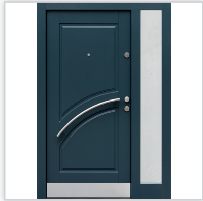
Drzwi wejściowe zewnętrzne model 556,1 z opcjonalnymi dostawkami bocznymi we wspólnej ramie. Grubość [mm]: 72, 82 i 102. Wysokość ościeżnicy [mm]: 209. Szerokość całej zabudowy od 140 do 255 cm. Wyposażenie: zamek listwowy klasy „C” na dwie wkładki, 4 blokady antywłamaniowe. Szklenie: pakiet 3 lub 4 szybowy z szybą niskoemisyjną P1. Materiał: klejone warstwowo drewno mahoń-meranti. Ocieplenie [mm]: 58-84. Współczynnik przenikania ciepła U_g [W/(m 2 K)]: od 0,55. Gwarancja: do 4 lat.
