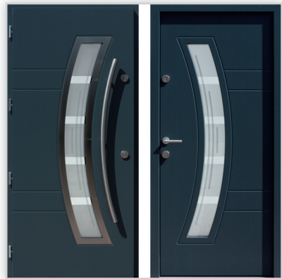
Drzwi wejściowe zewnętrzne model 447,1-447,11 systemu E-82. Wymiary zewnętrzne ościeżnicy [cm]: 98/209. Grubość [mm]: 72, 82 i 102. Wyposażenie: zamek listwowy klasy „C” na dwie wkładki, 4 kołki antywłamaniowe. Szklenie: pakiet 3 lub 4 szybowy z szybą niskoemisyjną P1. Materiał: klejone warstwowo drewno mahoń-meranti. Ocieplenie [mm]: 58-84. Współczynnik przenikania ciepła U_g [W/(m 2 K)]: od 0,55. Gwarancja: do 4 lat.
