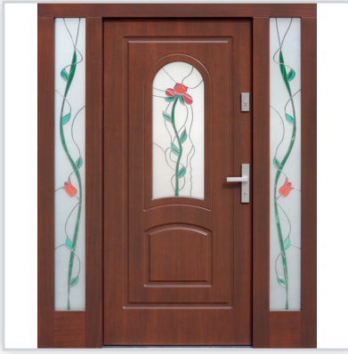
Drzwi wejściowe zewnętrzne model 576s1 z opcjonalnymi dostawkami bocznymi we wspólnej ramie. Grubość [mm]: 72, 82 i 102. Wysokość ościeżnicy [mm]: 209. Szerokość całej zabudowy od 140 do 255 cm. Wyposażenie: zamek listwowy klasy „C” na dwie wkładki, 4 blokady antywłamaniowe. Szklenie: pakiet 3 lub 4 szybowy z szybą niskoemisyjną P1. Materiał: klejone warstwowo drewno mahoń-meranti. Ocieplenie [mm]: 58-84. Współczynnik przenikania ciepła U_g [W/(m 2 K)]: od 0,55. Gwarancja: do 4 lat.
