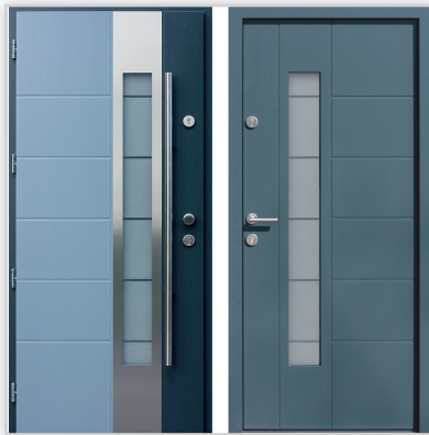
Drzwi wejściowe zewnętrzne model 471,2-471,12 systemu E-82. Wymiary zewnętrzne ościeżnicy [cm]: 98/209. Grubość [mm]: 72, 82 i 102. Wyposażenie: zamek listwowy klasy „C” na dwie wkładki, 4 kołki antywłamaniowe. Szklenie: pakiet 3 lub 4 szybowy z szybą niskoemisyjną P1. Materiał: klejone warstwowo drewno mahoń-meranti. Ocieplenie [mm]: 58-84. Współczynnik przenikania ciepła U_g [W/(m 2 K)]: od 0,55. Gwarancja: do 4 lat.
